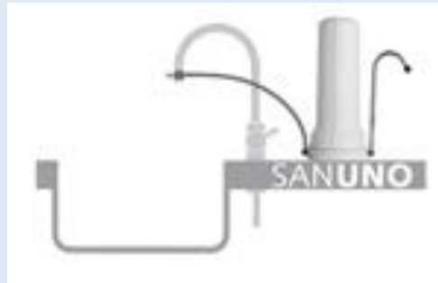
Auftischgehäuse mit Aktivkohleblock Von Carbonit
